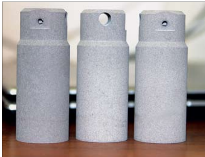
Метод микродугового оксидирования широко применяется для получения покрытий с заданными свойствами. Фото Московского гальванического центра.
